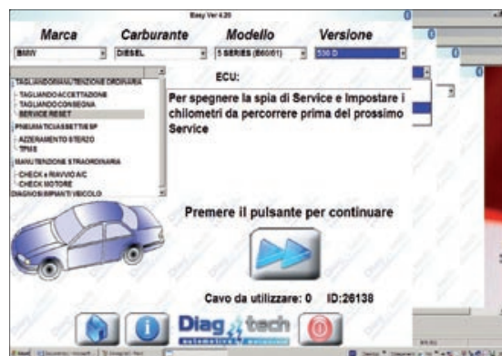
La videata dell'Easy System mostrata nell'immagine, è relativa allo spegnimento della spia SERVICE che indica la necessità di effettuare il tagliando.
