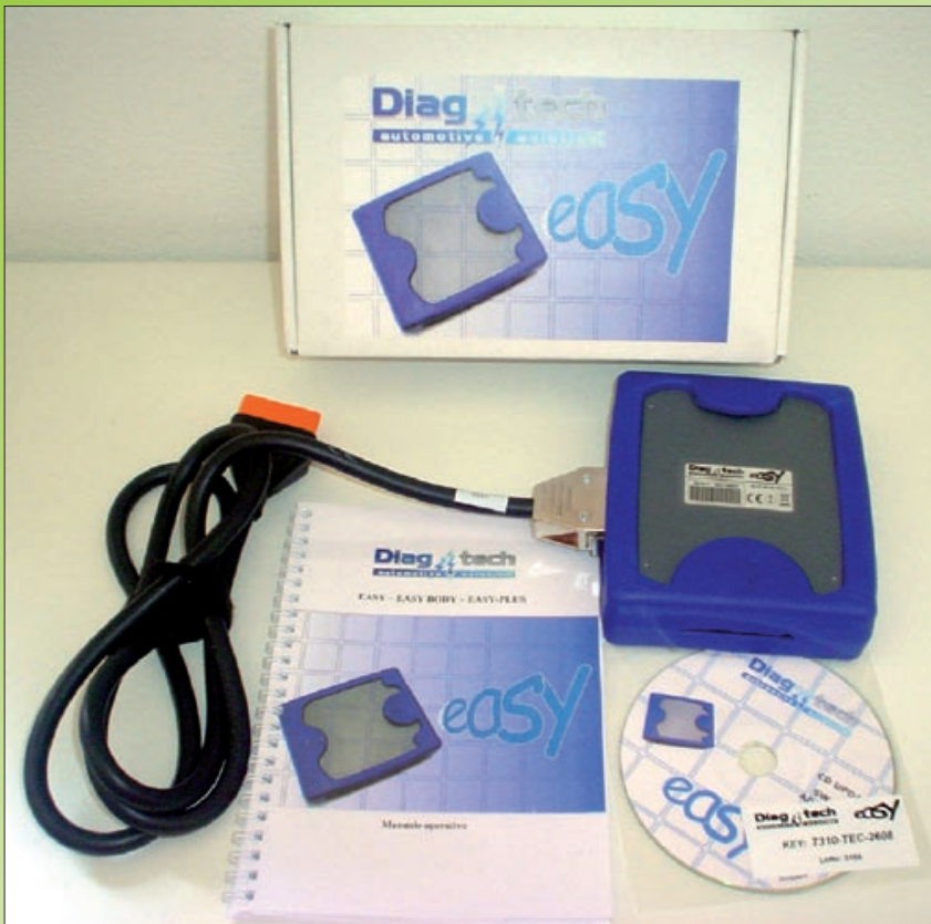
Easy System di Diagtech è uno strumento estremamente semplice da utilizzare, la confezione contiene tutto il necessario per potersi collegare alla presa diagnosi della vettura e dialogare con le varie centraline.
