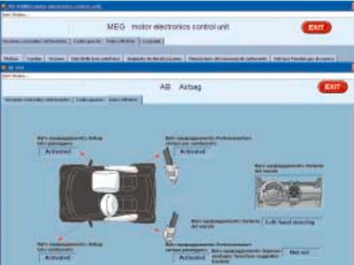
**Sopra, anche tra i sistemi di sicurezza le informazioni fornite da MAGUS sono di facile interpretazione. Nell'esempio si possono chiaramente osservare gli airbag e i pretensionatori attivati.**
