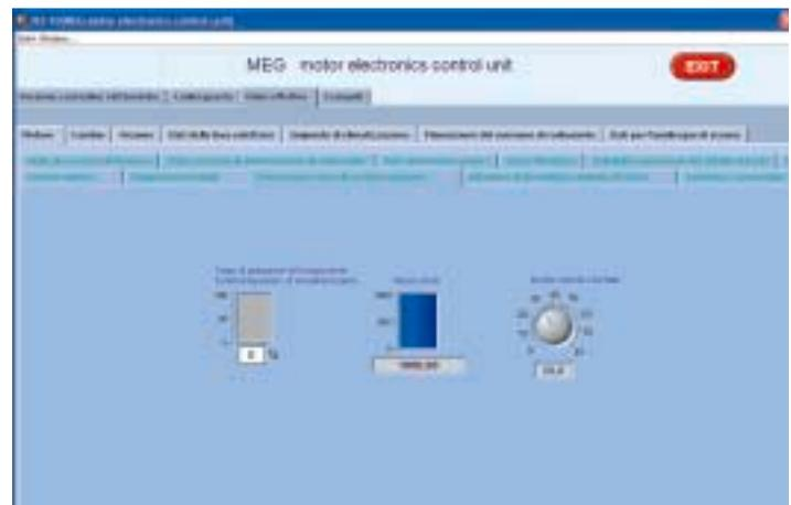
Nelle tre figure a sinistra, entrando nel software e collegando lo strumento alla vettura, vengono riconosciuti automaticamente il modello, la motorizzazione e persino l'allestimento. Volendo, è comunque possibile operare una selezione manuale attraverso i menù di scelta.
