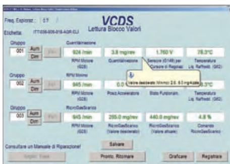
La videata del VCDS mostra alcuni dei parametri ingegneristici, che identificano il funzionamento del motore. Il software mostra anche il tool tip che compare, quando si pone la freccia del mouse sul dato di interesse.
