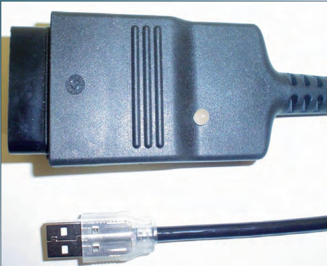
Per utilizzare il VCDS è sufficiente collegarlo alla vettura tramite la presa EOBd e al computer tramite una qualsiasi porta USB.
