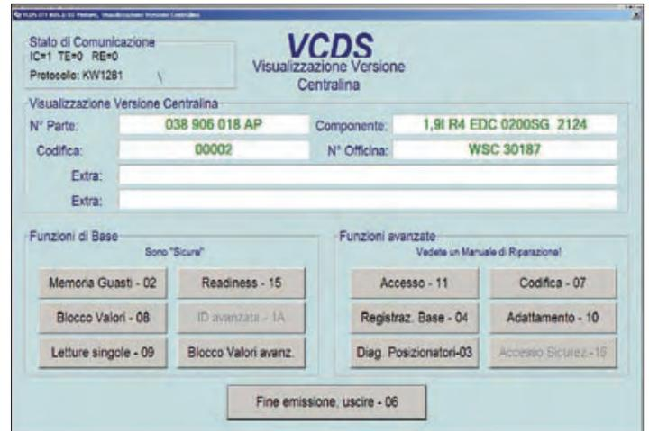
La videata del VCDS mostra i dati relativi ad una centralina montata sul veicolo e il gruppo base od avanzato di funzioni attuabili e con i quali è possibile operare sulla centralina stessa (le funzioni avanzate sono sostanzialmente relative alla riprogrammazione, mentre quelle base riguardano le letture).
