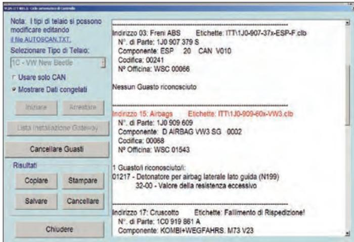
Lo strumento VCDS può effettuare una interpellazione automatica delle centraline montate a bordo della vettura, verificando se nella loro memoria sono presenti degli errori. Una funzione successiva permetterà di analizzare in modo più approfondito ciascuna anomalia.
