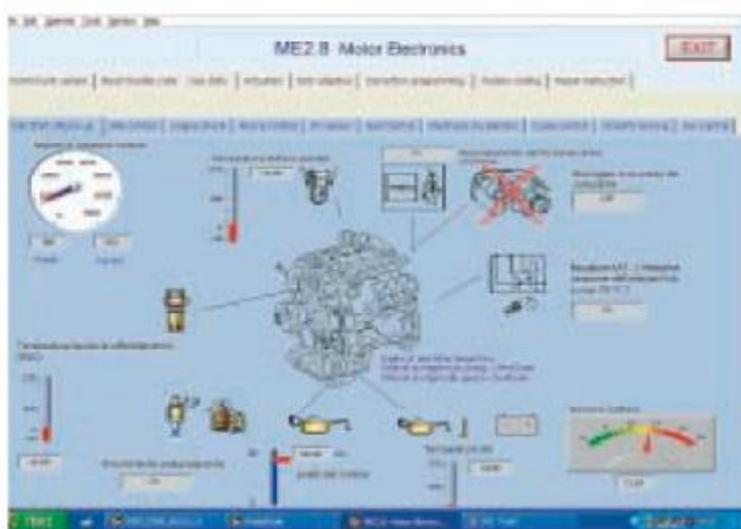
Sopra, il sensore di battito ha un ruolo cruciale nel buon funzionamento dei moderni motori. Nel caso della SL 55 AMG ve ne sono due, uno per bancata, e le informazioni da essi provenienti possono essere visualizzate attraverso il Win-Star. Sotto, le due immagini mostrano le differenti letture visualizzate variando l'altezza da terra della Mercedes da noi testata. Una soluzione possibile grazie agli ammortizzatori a controllo elettronico che offrono sempre il miglior assetto per la vettura.
